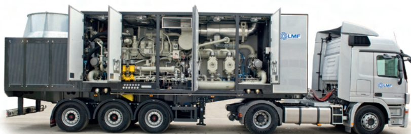
Vollautomatisierte, autarke Kompressoranlagen zur Evakuierung von Erdgas aus Pipelines im Rahmen von Wartungs- und Reparaturmaßnahmen.
